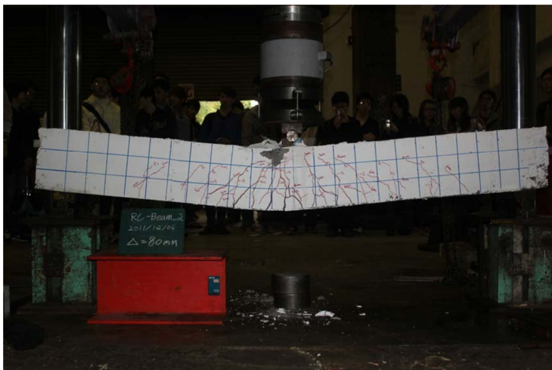
圖 C2.8 壓力區混凝土產生剝落
