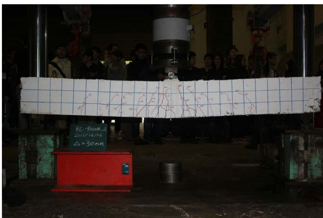
圖 C2.7 裂縫逐漸往壓力區延伸
