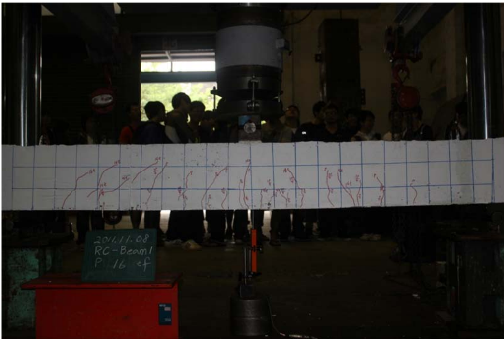
圖 C1.6 裂縫逐漸往壓力區延伸
