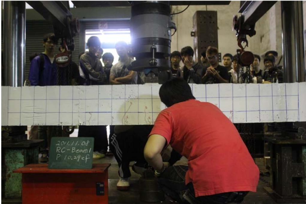
圖 C1.5 梁下方混凝土開裂
