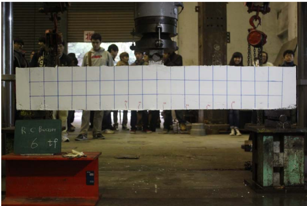
圖 C3.6 力量持續加載裂縫卻沒有顯著的增加
