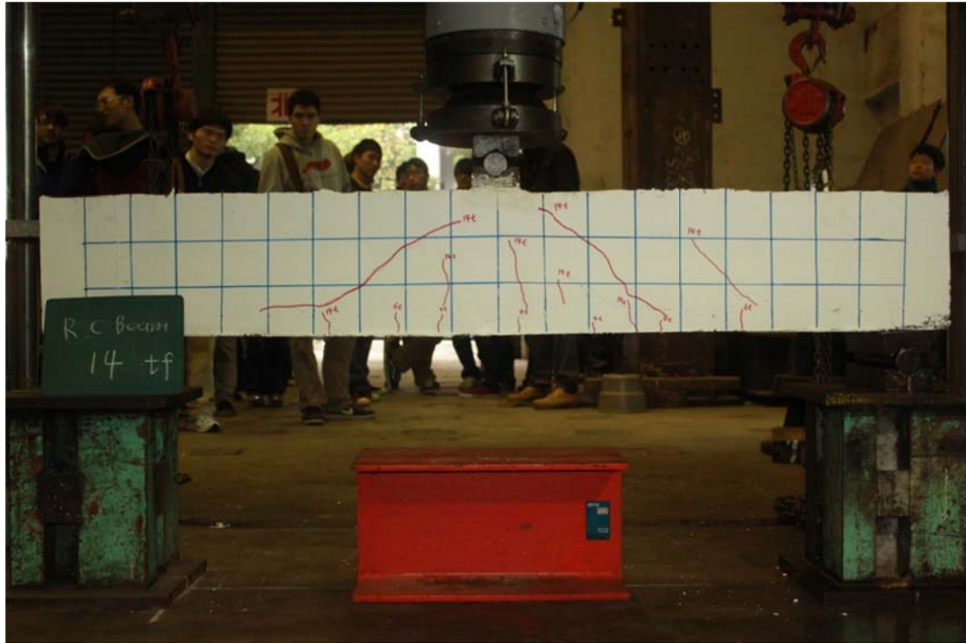
圖 C3.7 剪力裂縫產生並逐漸往壓力區延伸
