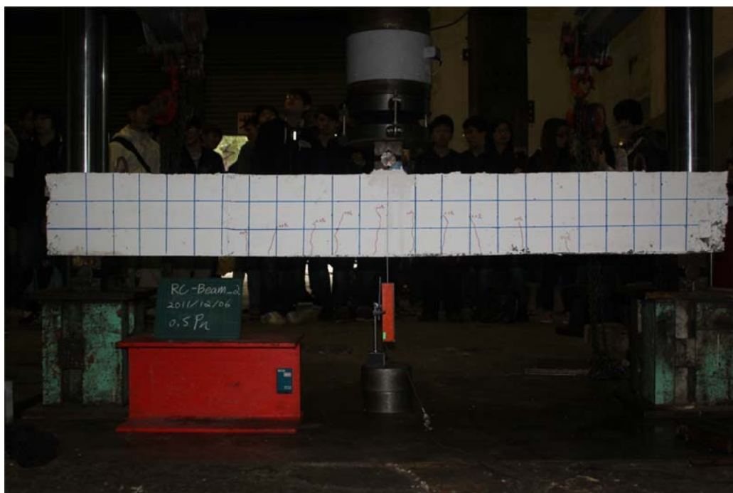
圖 C2.6 撓曲裂縫產生
