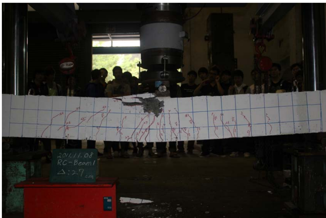
圖 C1.7 壓力區混凝土產生剝落
