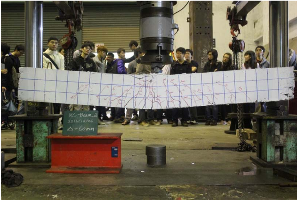
圖 1. 同學觀看梁破壞之情形
