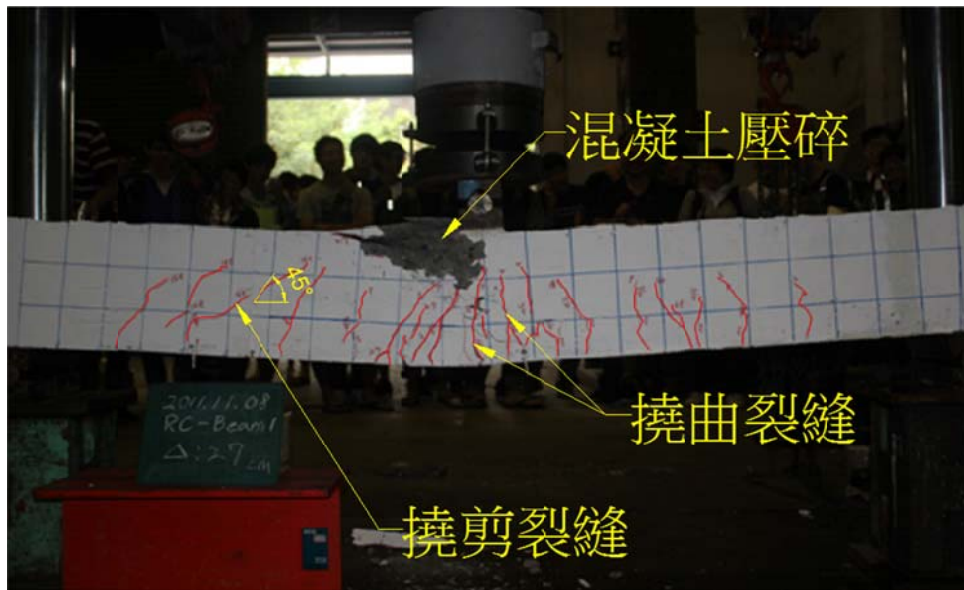
圖 C4.1 試驗一(無壓力筋)之最終破壞結果
